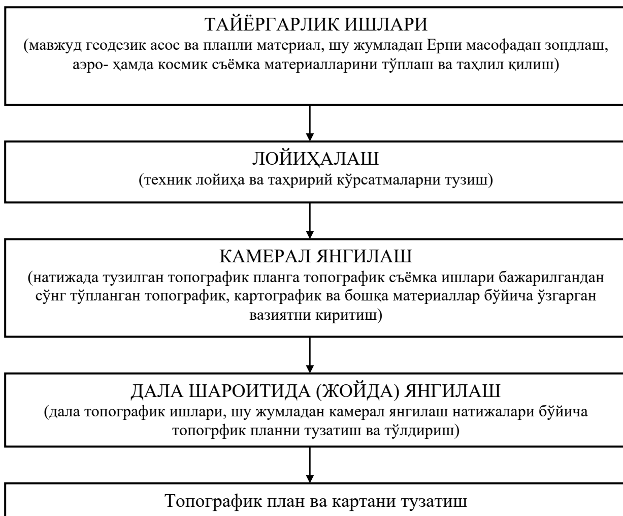
2-расм. Топографик планларни янгилашнинг технологик схемаси
