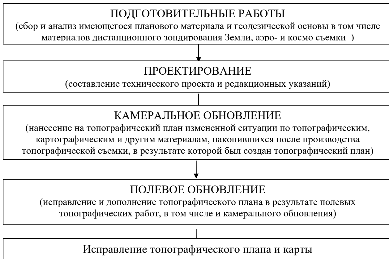
Рис.2. Технологическая схема обновления топографических планов
